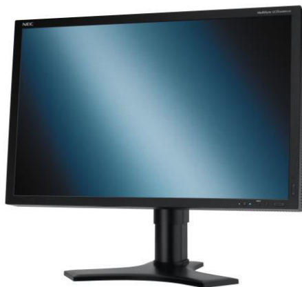
Obrazovka NEC 2690WUXi, rozlišení 1900 x 1200, velikost 550x344 mm (25,5"), panel H-IPS A-TW Pol. (Horizontal IPS with Advanced True Wide Polarizer).
